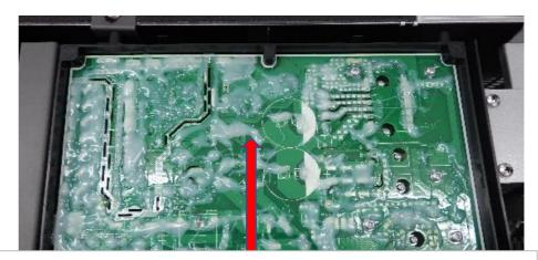
ヒートポンプ内部基盤部分シリコンによるコーティング済み
