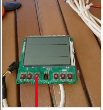
操作盤スイッチ部分の金具に錆が発生
